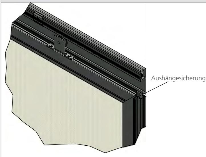
Montage der Aushängesicherung am oberen Eck des Rahmenprofils um ein unbeabsichtigtes Aushängen der Schiebetür zu verhindern.
