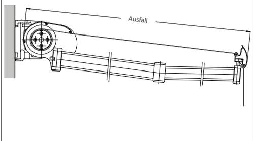
Aluminium; stranggepresst; pulverbeschichtet; C-förmig; integrierte Regenrinne für Wasserablauf; seitliche Endkappen aus Kunststoff passend
