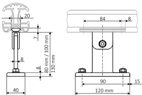
Aluminium; Standardlänge 80, 100 und 130 mm; Sonderlänge (Aufpreis); Sonderlänge bis max. 400 mm; Höhe verstellbar +/- 7 mm; bis 350 cm Ausfall 2 Stk, darüber 3 Stk je Schiene; alternativ mit Nischen-Konsole oder Nischen-Winkel
