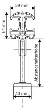
Aluminium; stranggepresst; 59 x 64 mm; Oberfläche pulverbeschichtet; inkl. Aluminium-Endkappe; bei Mehrfachanlage mit Doppelführungsschiene
