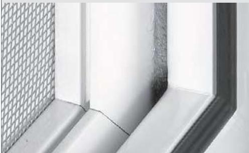
qualitativ hochwertige Dichtbürste; grau; Standard Höhe 3 mm (Typ1); optional Höhe 7 mm (Typ2) oder 16 mm (Typ3); umlaufend zum Fenster; optional für Nische
