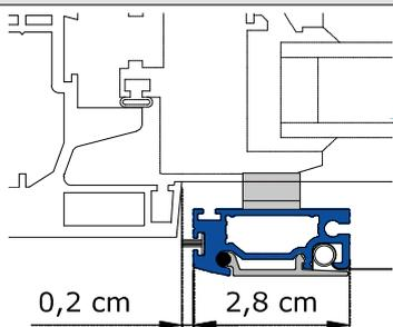
Aluminium; stranggepresst; 28 x 12 mm; pulverbeschichtet; auf Gehrung geschnitten; inkl. Aluminium Blende als Abdeckung für unsichtbaren Keder
