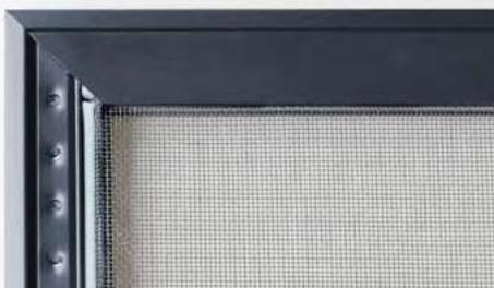
Eckverbindung auf Gehrung geschnitten und verpresst inkl. Clipsystem mit Abdeckung für unsichtbare Kederhalterung.
