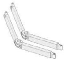
Aluminium; stranggepresst; pulverbeschichtet; Gelenke aus Aluminium-Druckguss; Kraftübertragung mit innenliegenden Federn und Stahllitzen verstärktem Gelenkband
