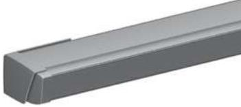
2 mm starkes Aluminium; stranggepresst; Oberfläche pulverbeschichtet; zweiteilig; Abmessung 165 x 261 mm; obere Abdeckung abnehmbar; Seitenteile Aluminium-Druckguss; Dichtprofil aus Silikon; optional; LED-Beleuchtung zur bauseitigen Verkabelung in Nut über die Länge der Kassette geführt
