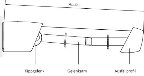
Aluminium; stranggepresst; C-förmig; pulverbeschichtet; seitliche Endkappen aus Aluminium-Druckguss
