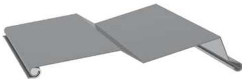
Z-förmige Lamelle, beidseitig randgebördelt, aus hochfester Aluminiumlegierung einbrennlackiert, tiefgezogene Aufzugsbandstanzung zur Schonung der Aufzugs-Textbänder, Metallführungszapfen wechselseitig mit jeder Lamelle vernietete, Lamellen mit fixierter Dämpfungslippe, Farbauswahl lt. gültiger Kollektion; WENDUNG: 90°
