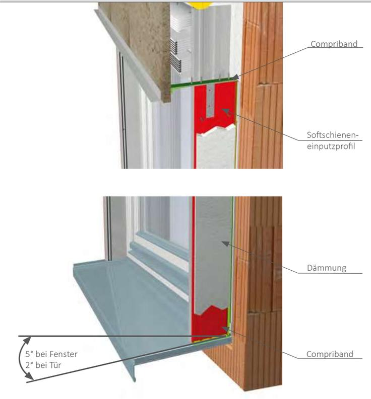
Aluminium; stranggepresst; blank; inkl. Dämmung
