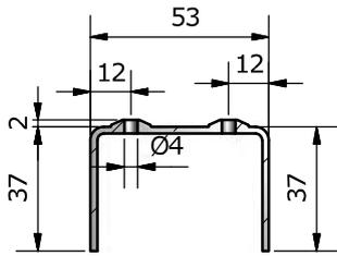
Das Softschienenabschlussprofil schließt bei einer Kombination über mehrere Elemente die dem Innenraum zugewandte Rückseite der Doppelführungsschiene und sorgt für seine Stabilität. Die Befestigung erfolgt mittels Verschraubung an Stock und Schacht.
