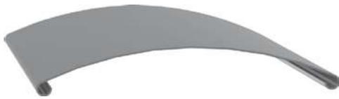
C-förmige Lamelle, beidseitig randgebördelt, aus hochfester Aluminiumlegierung einbrennlackiert, tiefgezogene Aufzugsbandstanzung zur Schonung der Aufzugs-Textbänder, Kunststoffführungsbolzen wechselseitig mit jeder Lamelle verbunden, Farbauswahl lt. gültiger Kollektion
