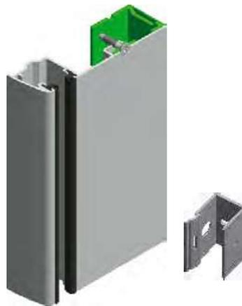
Patentierter VALETTA Softführungsschiene mit geräuschkämpfender Gummieinlage für einen absolut leisen Lauf des Behanges oder mit Soft-Fin Bürste für einen weichen Lauf bei der Rollladenkomplettierung. Befestigung mit Montage Clip am Fensterstock ohne sichtbare Schrauben; Aufputz oder Einputz (mit Softschieneinputzprofil). Kombinierbar mit Insektenschutzführungsschiene.
