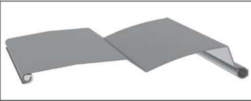
Z-förmige Lamelle, beidseitig randgebördelt, aus hochfester Aluminiumlegierung einbrennlackiert, tiefgezogene Aufzugsbandstanzung zur Schonung der Aufzugs-Textbänder, Metallführungszapfen wechselseitig mit jeder Lamelle vernietete, Lamellen mit fixierter Dämpfungslippe, Farbauswahl lt. gültiger Kollektion; **WENDUNG: 90°**; **OPTION: Tageslichtlamelle, zweifärbig**
