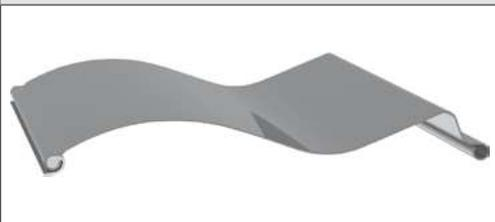
S-förmige Lamelle, beidseitig randgebördelt, aus hochfester Aluminiumlegierung einbrennlackiert, tiefgezogene Aufzugsbandstanzung zur Schonung der Aufzugs-Textbänder, Metallführungszapfen wechselseitig mit jeder Lamelle vernietete, Lamellen mit fixierter Dämpfungslippe, Farbauswahl lt. gültiger Kollektion; **WENDUNG: 90°**; **Option: Panoramawendung 120° (ohne Aufpreis)**,
