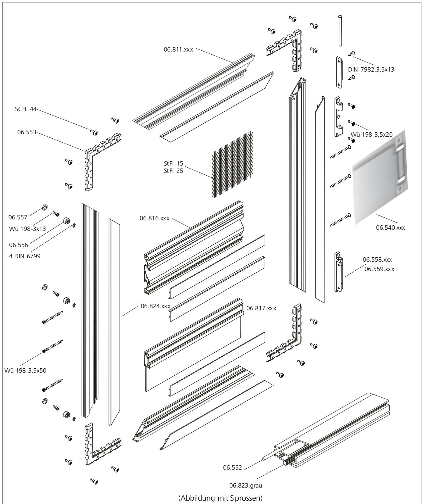
**PFLEGEHINWEIS:** Reinigung des Insektenschutz-Gewebes mit weicher Bürste, oder mit einer schwachen Seifenlauge abwischen. Bewegliche oder aufeinandergleitende Teile in regelmäßigen Abständen mit einem Schmiermittel versehen.
