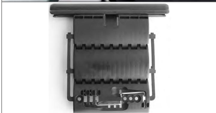
Die Wellenverbinder wird mit dem Spanndraht über die rechteckigen Ausstanzungen mit der Achtkantwelle verbunden. Die Haken sind in den Ausstanzungen der Welle einzuhängen. Die Haltespange herunter drücken und Haltespange einklipsen.
