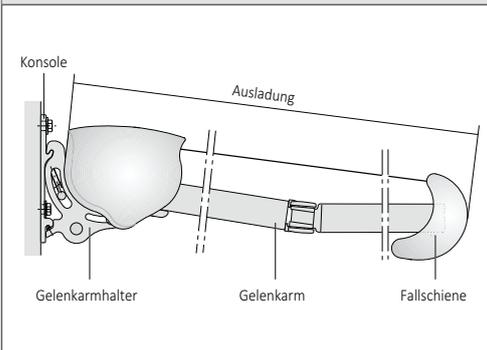
Aluminium; stranggepresst; C-förmig; pulverbeschichtet; seitliche Endkappen aus Aluminium-Druckguss; optional; Ausführung mit Senkrechtrollo Vertima; bis max. Breite 600 cm und Ausfall 300 cm
