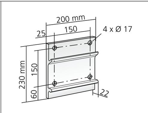
Mitgelieferten Montagekonsolen sind für die Befestigung auf Beton C20/25 vorgesehen. Andere Montageuntergründe sowie Befestigung auf Isolierputz müssen bei der Bestellung vermerkt werden, da hierfür ggf. aus statischen Gründen andere Montagekonsolen bzw. anderes Zubehör notwendig ist (Aufpreis). Beachten Sie hierbei die Auszugskräfte.
