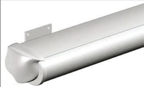
2 mm starkes Aluminium; stranggepresst; Oberfläche pulverbeschichtet; zweiteilig; Abmessung 164 x 242 mm; obere Abdeckung abnehmbar; Seitenteile Aluminium-Druckguss; Dichtprofil aus Silikon
