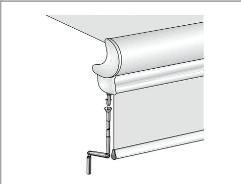
Stufenlose Höhenverstellung mittels Getriebe mit Trichterkerbel; Stoffhöhe ca. 150 cm; bis Ausfall max 300 cm
