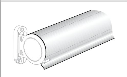
C-förmige Rundhülse aus Aluminium, stranggepresst,  $\varnothing$  123 mm x 2 mm, für den ganzjährigen Wetterschutz von Tuch und Technik. Ausgestattet mit Radien am Tuchaustritt, Tropfkante sowie Kompensation der Längenausdehnung in den Seitenlagern. Aufpreis Aluminium Abdeckung LS, LF
