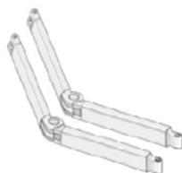
Aluminium; stranggepresst; pulverbeschichtet; Gelenke aus Aluminium-Druckguss; Kraftübertragung mit innenliegenden Federn und Stahlritzen verstärktem Gelenkband; Armlager mit Kippgelenk und integrierter Hochschlagsicherung
