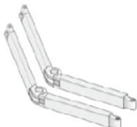
Aluminium; stranggepresst; pulverbeschichtet; Gelenke aus Aluminium-Druckguss; Kraftübertragung mit innenliegenden Federn und Stahllitzen verstärktem Gelenkband
