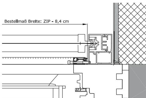
VORTEIL: Kombination ist mit Standard Führungsschiene möglich. Kein Distanzprofil notwendig. Daher auch einfach und schnell jederzeit nachrüstbar.
