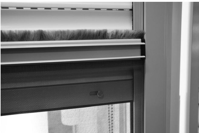
3. Zum Entriegeln des PCI die PCI-Schiene hoch heben, Metallzapfen auf die andere Seite schieben. PCI funktioniert wieder ohne Rollladen.
