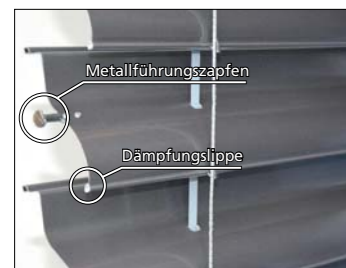
Lamellen werden wechselseitig durch vernietete Metallführungszapfen in den Schienen geführt
