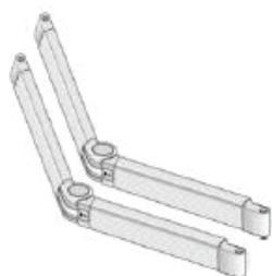
Aluminium; stranggepresst; pulverbeschichtet; Kraftübertragung mit innenliegenden Doppelfederzügen; Federspannung mittels spezieller rostfreier Edelstahl Flyerkette; Gelenkarm beidseitig einsetzbar
