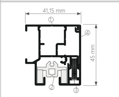
Aluminium; stranggepresst; zweiteilig; Kunststoff-Laufnut zur Führung des Tuchs mit ZIP-Verschluss; Oberfläche pulverbeschichtet; inkl. Aluminium-Endkappe
