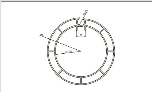
Rundnutwelle; Aluminium; 1,5 mm; doppelwandig; Ø 100 mm
