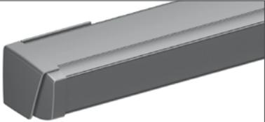
2 mm starkes Aluminium; stranggepresst; Oberfläche pulverbeschichtet; zweiteilig; Abmessung 165 x 261 mm; obere Abdeckung abnehmbar; Seitenteile Aluminium-Druckguss; Dichtprofil aus Silikon; optional; LED-Beleuchtung zur bauseitigen Verkabelung in Nut über die Länge der Kasette geführt
