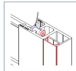
Sicherheits-Führungsschiene FS576 76 x 32 mm gewährleistet Windwiderstandsklasse 6
