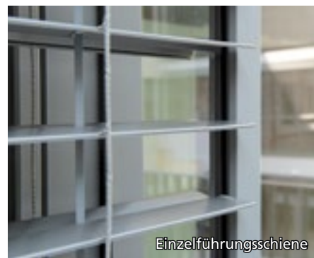
Führungsschiene eckig, aus stranggepresstem Aluminium zur Montage über Abstandhalter mit Klemmhalterung (KLK). Führung mit schwarzem, geräuschkämmenden koextrudiertem Clip-Keder für eine geräuschlose Fahrt des Behangs.
