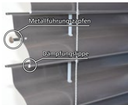
Lamellen werden wechselseitig durch vernietete Metallführungszapfen in den Schienen geführt Dämpfungslippe seitlich fixiert gegen Einziehen
