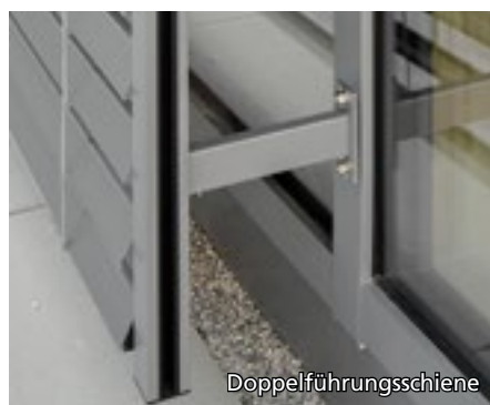
Führungsschiene eckig, aus stranggepresstem Aluminium zur Montage über Abstandhalter mit Klemmhalterung (KLK). Führung mit schwarzem, geräuschkämmenden koextrudiertem Clip-Keder für eine geräuschlose Fahrt des Behangs.
