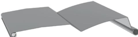
Z-förmige Lamelle, beidseitig randgebördelt, aus hochfester Aluminiumlegierung einbrennlackiert, tiefgezogene Aufzugsbandstanzung zur Schonung der Aufzugs-Textbänder, Metallführungszapfen wechselseitig mit jeder Lamelle vernietet, Lamellen mit fixierter Dämpfungslippe, Farbauswahl lt. gültiger Kollektion; **WENDUNG: 90°**
