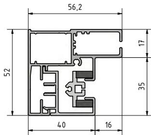
Zweiteilige Führungsschiene geklippt mit Kunststoffkeder zur Führung eines Textilen Screen-Behangs mit ZIP und zusätzlicher Führungskammer für die Insektenschutzgaze des ZRCI-H oder ZRCI-H-NF.
