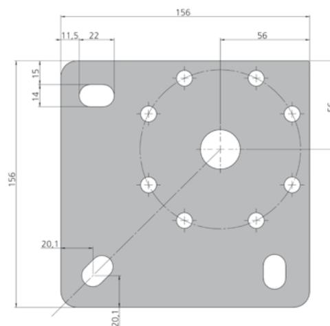
BODENPLATTE FLÄCHENBÜNDIG 105 / 105
