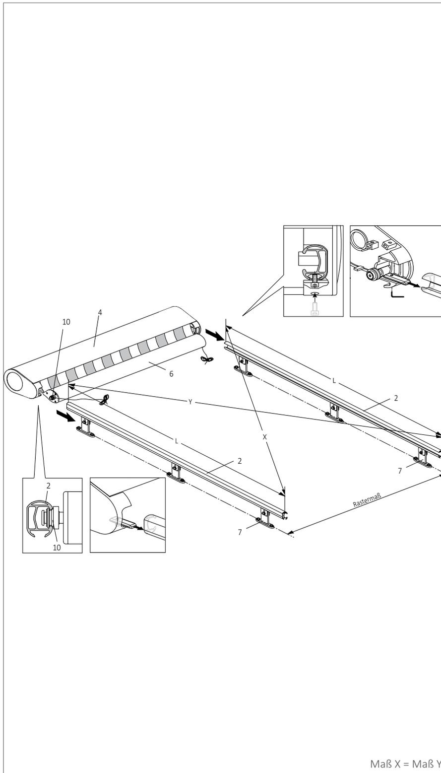
Klebebänder an der Verpackung der Antriebseinheit (4) seitlich lösen (die Folie bleibt zum Schutz und zur Sicherung über der Antriebseinheit (4) und Ausfallprofil (6), nur beide Enden öffnen! Nutensteine in Einbaulage ausrichten.
