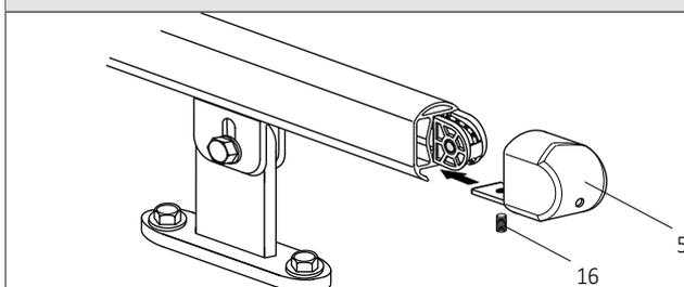
Endkappen (5) auf Führungsschienen aufstecken und mit Gewindestift (16) sichern.
