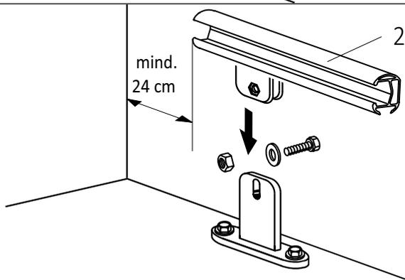
Führungsschiene (2) mit den Oberteilen der Abstandshalter auf die Abstandshalter aufstecken und die Führungsschiene mit einem Abstand von ca. 30 cm zur Wand schieben und verschrauben (Sechskantschraube M8 x 25, Unterlegscheibe ø8,4, Mutter M8).
