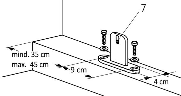
Befestigungspunkte für die Abstandshalter (7) nach Rastermaß festlegen, beim Anschluss an eine Wand sind die obersten Abstandshalter ca. 35-45 cm von der Wand anzubringen. Dies ist erforderlich, um die Antriebseinheit (4) mit Ausfallprofil (6) auf die Führungsschienen aufschieben zu können.
