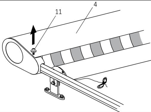
Folie von Antriebseinheit (4) komplett entfernen. Schraube (11) von der Abdeckung lösen.
