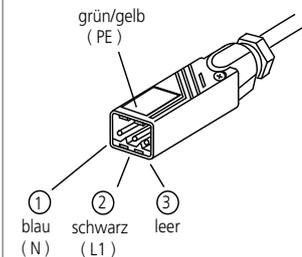
Der Motor muss entsprechend der Klemmenbelegung angeschlossen werden. Bei Anschlussarbeiten muss die Stromzufuhr unterbrochen werden (Sicherung herausnehmen!).
