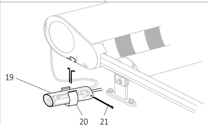
Schutzhülse (19) für Hirschmann-Kupplung mit Klammer (20) in die Nut des Bodenbleches einclipen. Hirschmannstecker mit Splint (21) sichern.
