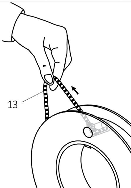
Die Knoten werden durch nach oben ziehen des Seiles in die Aussparungen der Seilscheiben gedrückt. Knoten darf seitlich nicht überstehen.
