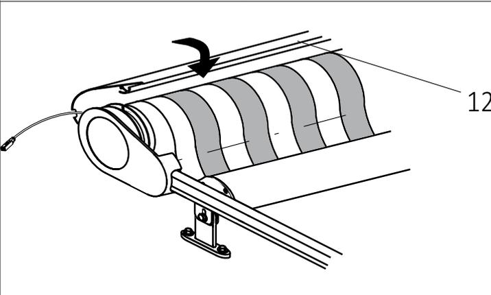
Vor dem Schließen der Abdeckung Motorkabel am Seitenlager entlang nach oben führen. Abdeckung (12) auf Bodenblech aufsetzen und schließen.
