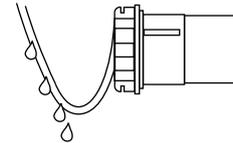
Um zu verhindern, dass Wasser in den Motor hineinläuft, sollte das Anschlusskabel immer mit einer Schleife nach unten verlegt werden.
