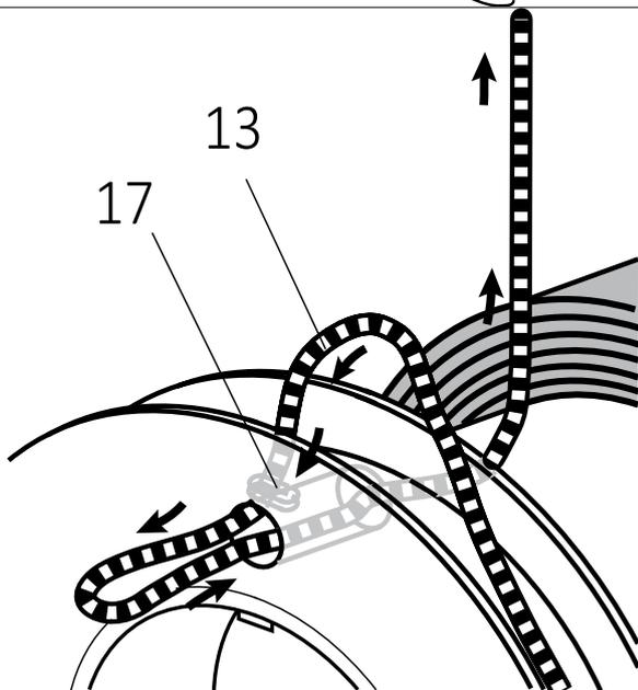
Seil (13) von oben durch die Aussparung der Seilscheibe (17) nach unten und durch die Aussparung wieder zurück in Richtung Tuchwelle ziehen.
