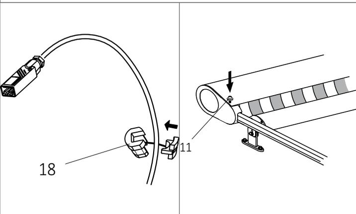
Anschließend Kabeldurchführung (18) um Kabel legen und zusammendrücken. Kabeldurchführung auf Deckel aufsetzen, Kabel glattziehen und in Deckblech Kabeldurchführung einclipen. Mit Schraube (11) die Abdeckung im Seitenlager wieder sichern.
