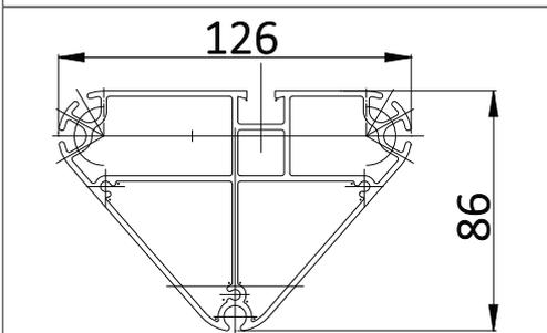
Fallschiene ab einer Breite von 3500 mm
