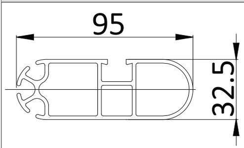
Fallschiene bis einer Breite von 3500 mm
