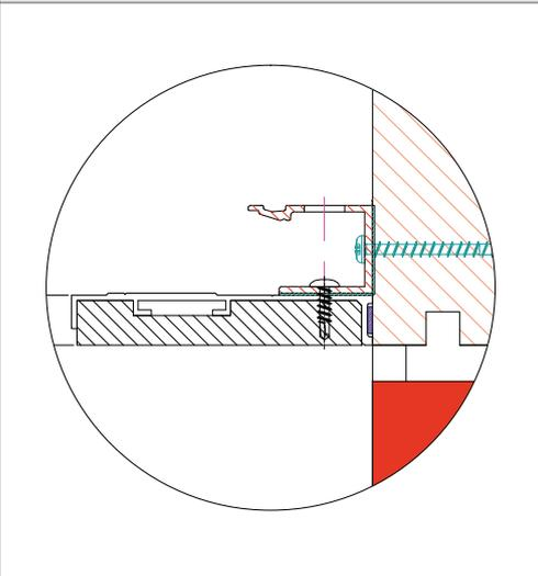
Aluminium; stranggepresst; blank; inkl. Dämmung
