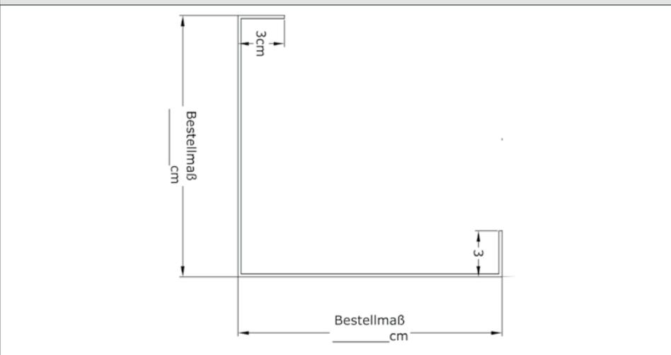
Eckverblendung aus 2 mm Aluminium gekantet
