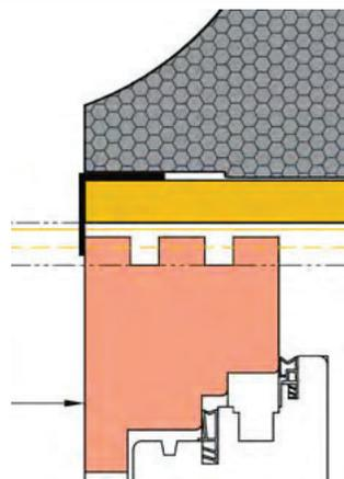
Formstabile Putznase aus stranggepresstem Aluminium; Materialstärke 2..
