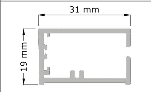
Aluminium; stranggepresst; 31 x 19 mm; Oberfläche pulverbeschichtet; inkl. Einlauftrichter (in FS eingesteckt, einfach austauschbar)
