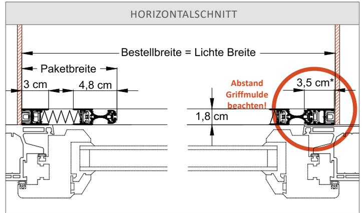
\* max. Abstand für optimale Verwendung der Griffleiste
