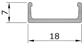
Bodenführungsschiene; Aluminium; stranggepresst; Standard Natur eloxiert; Höhe 7 mm; inkl. Entwässerungsauslauf; optional Bodenführungsschiene schräg 7°
